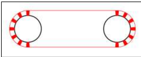
Obr. 7 Doporučený způsob instalace podkladnicové vazby nekonečnou smyčkou (2.3.11)
